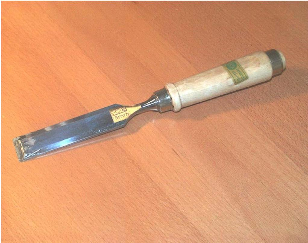
Das Stecheisen wird zum Herstellen von Holzverbindungen verwendet.
