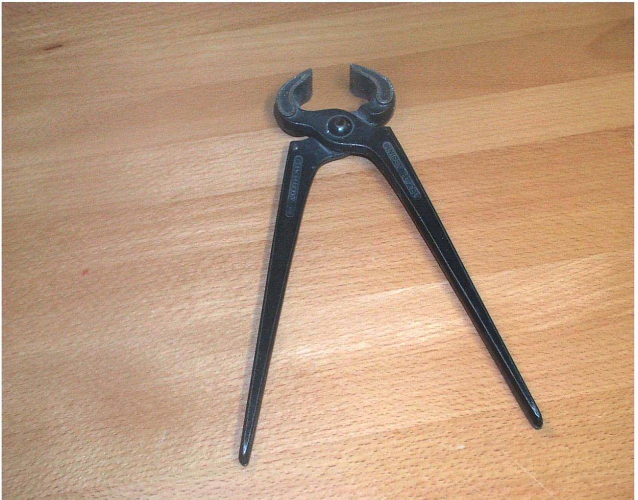
Die Kneifzange dient zum Ausziehen und Abkneifen von Nägeln
