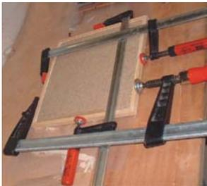
Die 4 Holzleisten werden an die Spanplatte angedrückt.
