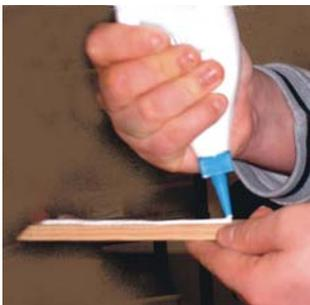
Um die Holzleisten an der Spanplatte befestigen zu können, brauchen Sie einen Holzleim.
